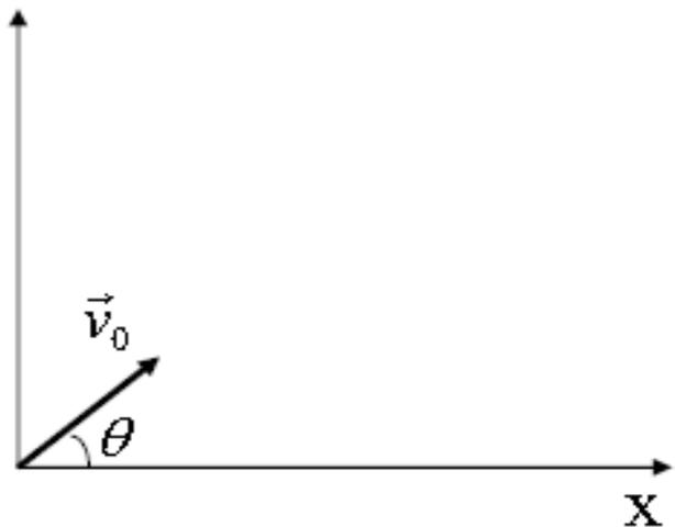
Lungo l'asse delle  $x$  non vi sono accelerazioni e quindi, lungo l'asse delle  $x$ , il moto è rettilineo uniforme, mentre lungo l'asse delle  $y$ , grazie alla costanza di  $g$ , sarà uniformemente accelerato.
