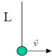
Consideriamo il pendolo di figura composto da un filo inestensibile lungo  $L$  ed una massa  $m$ . Forniamo alla massa una velocità  $v$  e ci domandiamo quale è l'altezza massima alla quale il pendolo risale.
