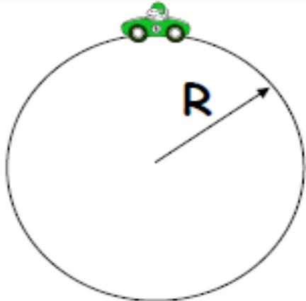
L'unica forza capace di produrre una accelerazione centripeta è la forza d'attrito fra le ruote e la strada. Quindi la massima forza d'attrito producibile pone un limite alla velocità con cui l'auto può percorrere la curva senza slittare.
