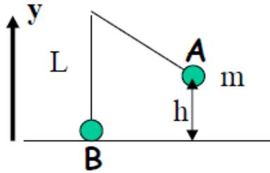
Consideriamo il pendolo di figura composto da un filo inestensibile lungo  $L$  ed una massa  $m$ . Facciamo partire, da fermo, la massa  $m$  da un'altezza  $h$  (punto A). Quanto vale la tensione  $T$  del filo nel punto B?
