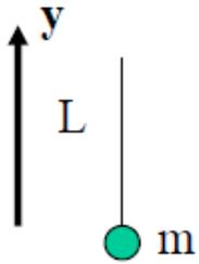
Consideriamo il pendolo di figura composto da un filo inestensibile lungo  $L$  ed una massa  $m$ . Calcolare la tensione del filo.
