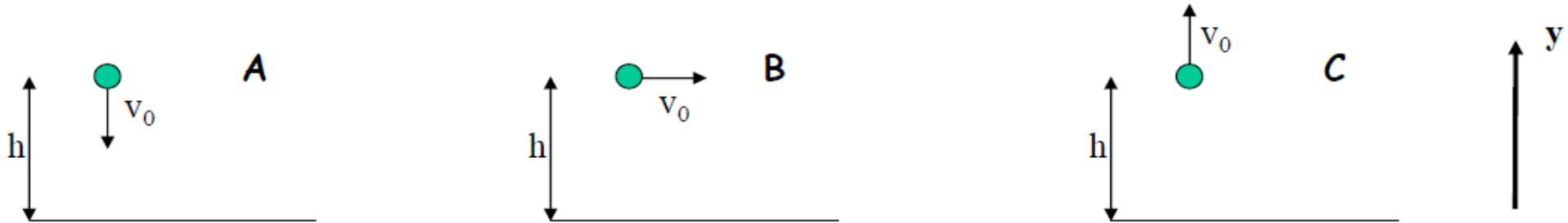
Consideriamo le tre masse identiche di figura: calcolarne i moduli delle velocità quando toccano il suolo ed i tempi di caduta.
