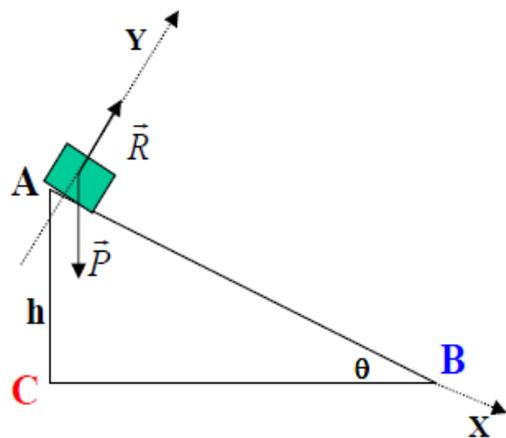
Vogliamo calcolare i moduli delle velocità, nel punto **B** e nel punto **C**, che avrà un corpo partito da fermo dal punto **A**, su di un piano inclinato alto  $h$ .
