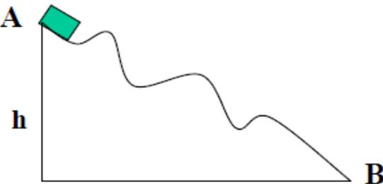
Vogliamo calcolare i moduli delle velocità, nel punto B, che avrà un corpo partito da fermo dal punto A, nel primo e nel secondo caso. In entrambi i casi le forze che agiscono sul corpo sono la forza peso e la reazione vincolare.
