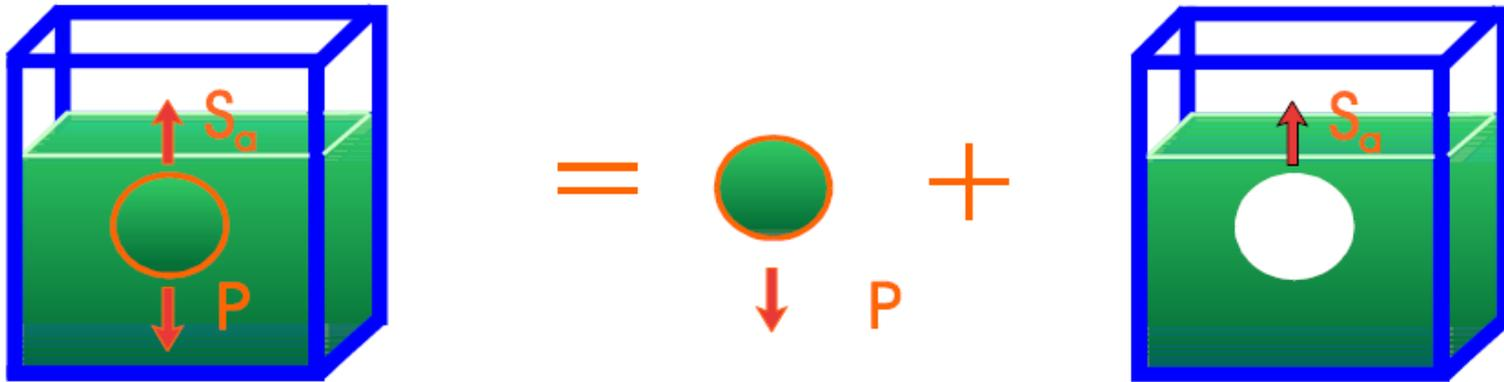
Un corpo immerso in fluido è sottoposto ad un sistema di forze, la cui risultante è detta spinta di Archimede  $S_a$ , diretta verticalmente verso l'alto ed uguale al **peso del volume di fluido spostato**
