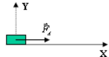
L'attrito in questione è quello statico ( $\mu_s$ ) perché, nel punto di contatto, il pneumatico è momentaneamente fermo, lungo il raggio della curva, rispetto alla strada. Se si supera  $v_{\max}$  l'auto inizia a slittare e la forza d'attrito diminuisce ( $\mu_d < \mu_s$ ) e quindi la macchina non si controlla.
