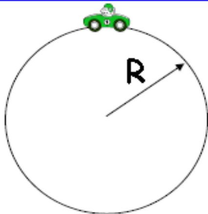
L'unica forza capace di produrre una accelerazione centripeta è la forza d'attrito fra le ruote e la strada. Quindi la massima forza d'attrito producibile pone un limite alla velocità con cui l'auto può percorrere la curva senza slittare.
