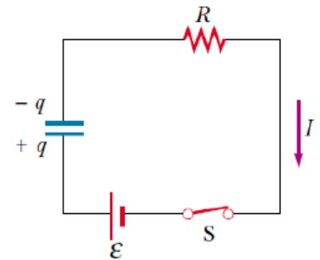
La carica è trasferita, lungo i fili, sulle armature dal campo elettrico prodotto dalla batteria, fino a quando il condensatore è completamente carico.
