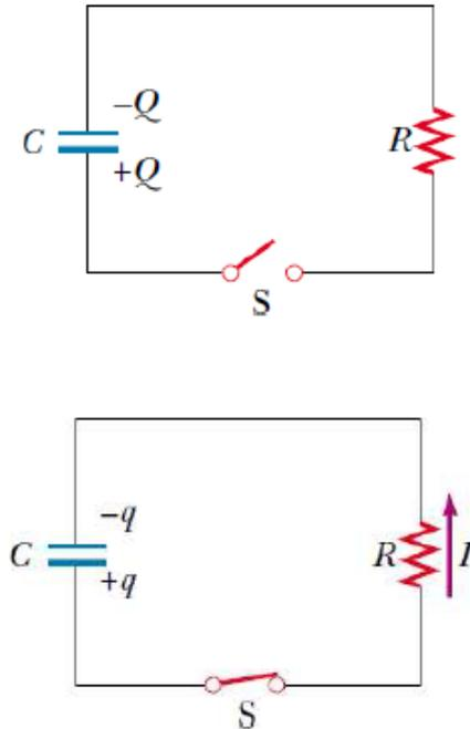
La carica  $Q$  è la massima carica portata dal condensatore. Quando il circuito è chiuso passa corrente dalla resistenza e la carica sulle armature comincia a diminuire.
