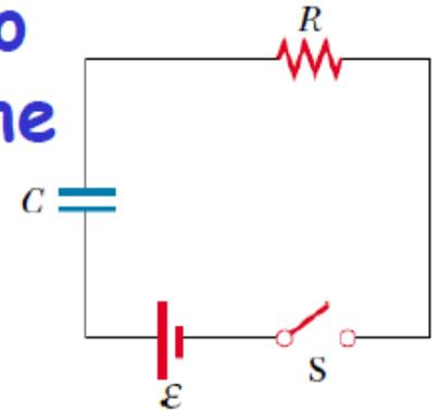
Notate che, durante la carica, la corrente non può passare attraverso il condensatore, perché lo spazio fra le due armature (isolante) è un circuito aperto.
