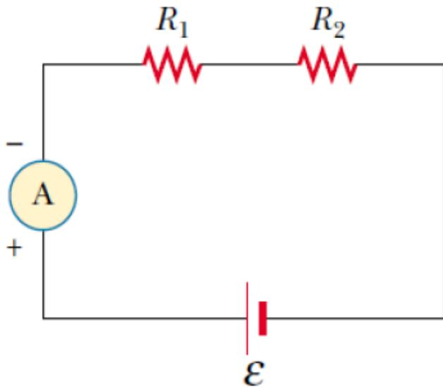
Nella realtà non esistono amperometri con resistenza interna nulla e nella configurazione di figura, la richiesta di  $R_{int}=0$  equivale a
